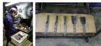
ステンレス素材を金型にて冷間成型。グリップ部を4つの金型でグリップ状に巻く。
